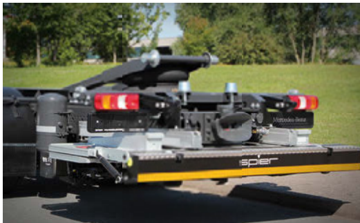
Hubschwingen zur stufenlosen Aufnahme von Wechselbehältern
