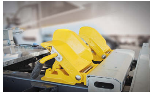
Dreistufige Höhenverstellung "Heavy Duty" mit integrierter Einweisführung
