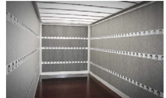
Zurmulden und Nadelfilzauskleidung sichern und schützen das Ladegut.
