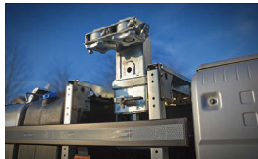
Leichtgängige gasfederunterstützte Höhenverstellung mit Doppelverriegelung für C 745 und C 782-Wechselbehälter
