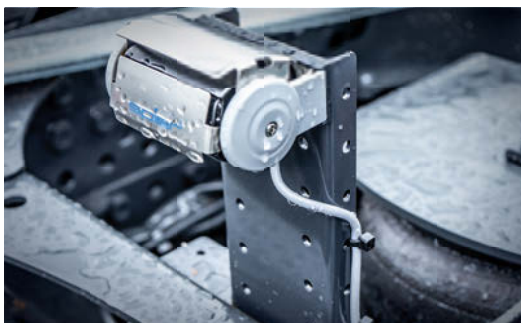
SPIER Wechselrahmen sind – speziell zum sicheren Aufkoffern mit MirrorCams – optional mit SPIER Rückfahrkameras erhältlich.
