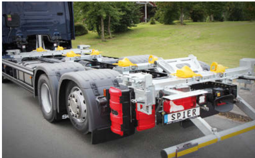
Wechselverkehrsrahmen in geschraubter feuerverzinkter Modulbauweise mit einfacher Höhenverstellung
