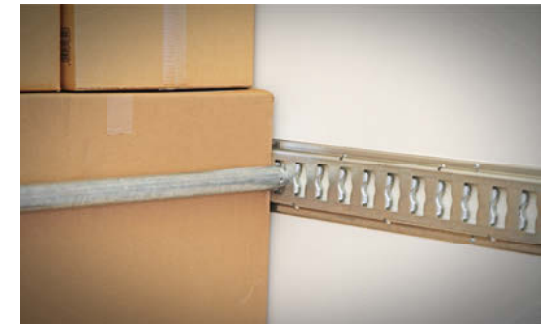
Horizontale Ladungssicherung mit Sperrstangen und Kombiankerschiene
