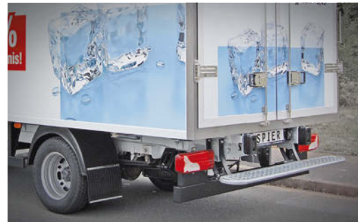
Federnder Hecktritt als ergonomischer Einstieg und Rammschutz am Heck
