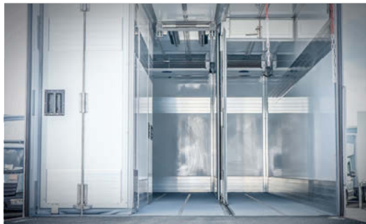
Längs- und Quertrennwände – für unterschiedliche Temperaturzonen kombiniert montierbar.
