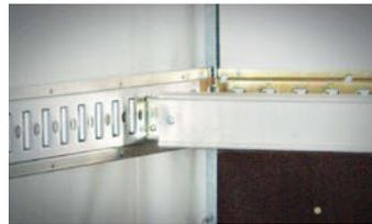
Einstecklatten mit Kombiankerschienen und Absperrbalken
