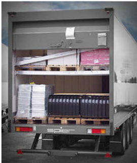
Heckportal mit Rolltor und Doppelstockbeladung
