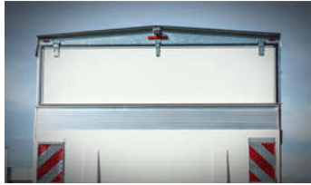
Serienmäßiges* Spitzdach zur Verminderung von Witterungsablagerungen
