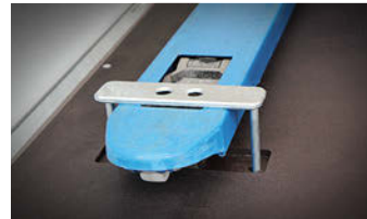
Hubwagenhalterung im Boden eingelassen
