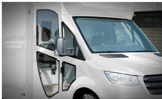
SP45plus: Zusätzliche Glasflächen auf der Beifahrerseite sorgen für mehr Sicherheit.
