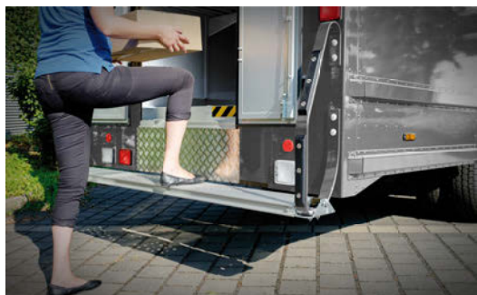
SP80 mit aufbaubündig zu öffnender zweiflügeliger Hecktür und ergonomischem Einstieg
