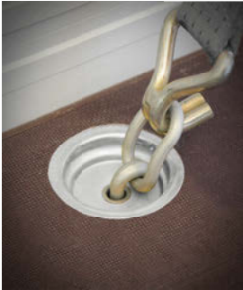
Bodenösen als Ladungssicherung
