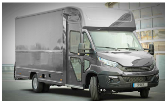
SP100: 7-Tonner mit seitlicher Schiebetür im Fahrerhaus und ca. 27,5 m 3 Ladevolumen.
