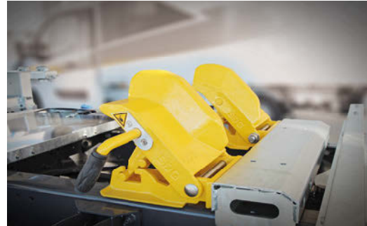
Dreistufige Höhenverstellung "Heavy Duty" mit integrierter Einweisführung
