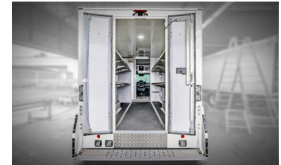
Markantes Heck des SP60plus mit zweiflügeliger Hecktür, gelenkschonendem Hecktritt und ca. 17 m 3 Laderaumvolumen
