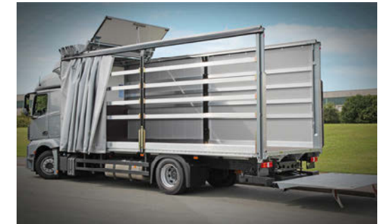
Schiebeverdeck zur optimalen Beladung von oben
