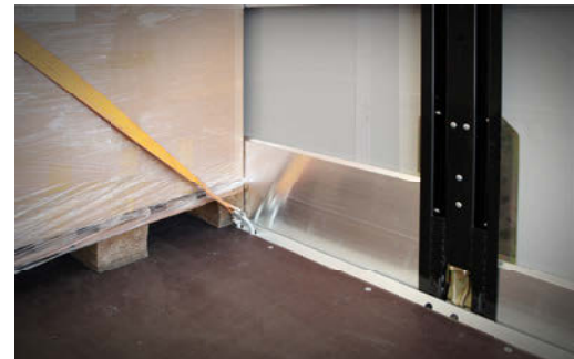
Einstecklatten als Palettenanschlag und im Außenrahmen integrierte Zurrbügel
