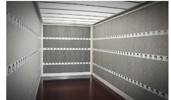
Zurrmulden und Nadelfilzauskleidung sichern und schützen das Ladegut.
