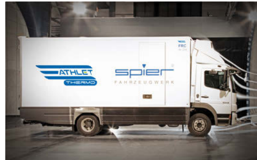
Der Athlet Thermo im Windkanal - ausgefeilte Aerodynamik sorgt für geringeren Kraftstoffverbrauch und weniger CO 2 -Emissionen.
