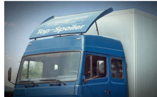
1974: SPIER Top Spoiler – erster kraftstoffsparender Luftleitkörper für Lkw-Fahrerhäuser
