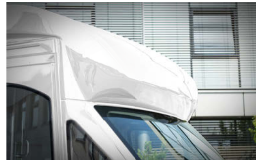
Strömungsgünstige Dachhaube folgt den Fahrzeuglinien außen und sorgt innen für mehr Ergonomie und Kopffreiheit
