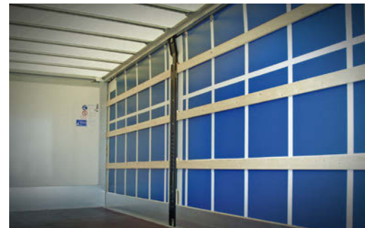
Innenansicht Curtainsider mit festem lichtdurchlässigen Dach und Alu-Einsteckprofil unten als Palettenanschlag
