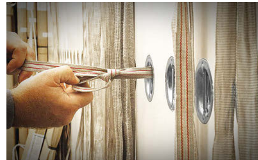
Flächenbündig eingelassene Zurrmulden als Ladungssicherung
