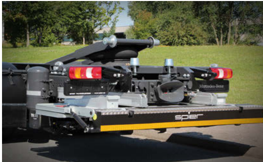
Hubschwingen zur stufenlosen Aufnahme von Wechselbehältern
